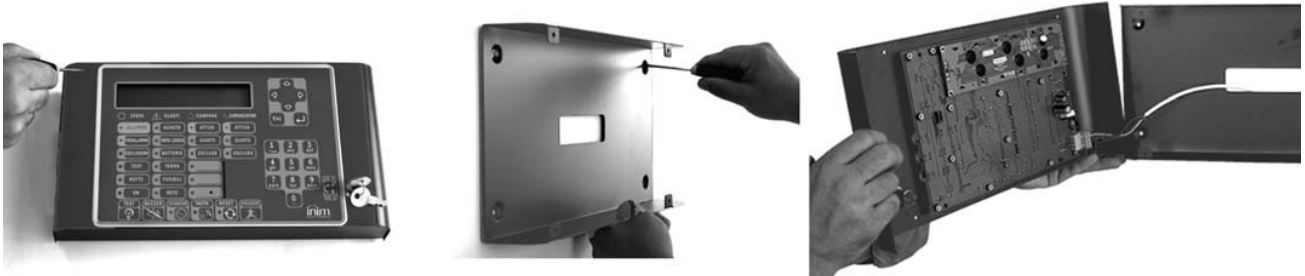
Rysunek 11 - Montaż terminala wyniesionego
